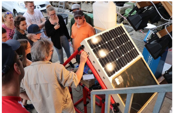
Le module éclairé au soleil artificiel, on voit quelques uns des 12 spots et leurs reflets
